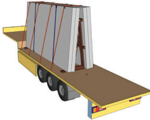
Figur 48: Fastgørelse med en kombination af blokering, A-ramme, rundsurring og surring over toppen
