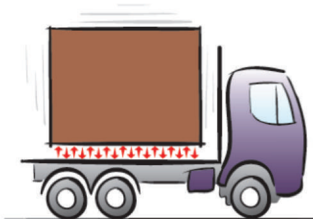
Figur 3: Vertikal vibration under kørsel
