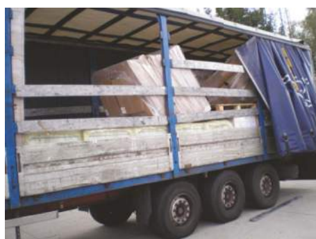
Figur 19: Utilstrækkelig fastgørelse af last udelukkende med strækfilm
