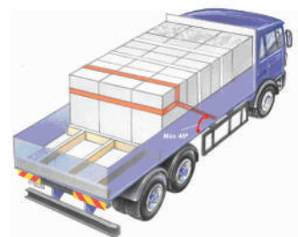
Figur 40: Fjederbelastet surring med sele
