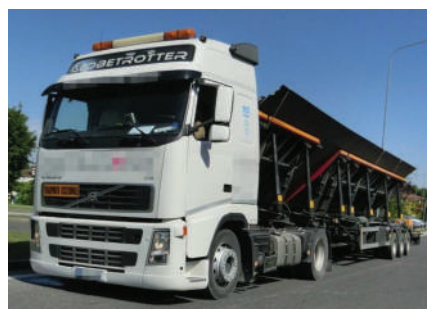
Figur 14: Stålplader transporteret under 45°
