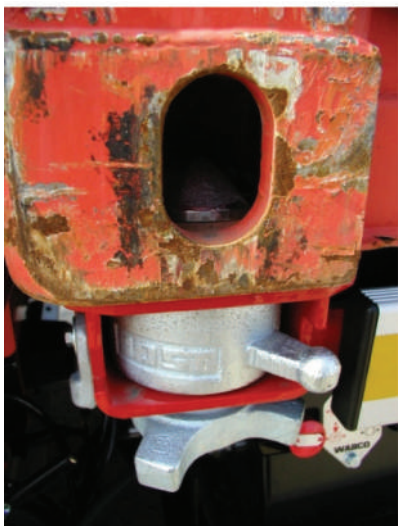
Figur 17: Drejelås med container
